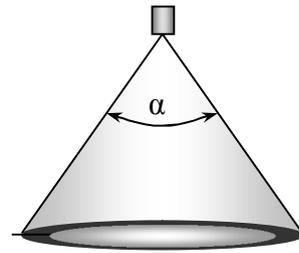
Форсунки серии **ТФ06** изготавливаются из латуни **ЛС59**. По специальному запросу форсунки могут быть изготовлены из нержавеющей стали **12Х18Н10Т**
